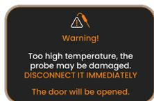
Com a Sonda inserida e a temperatura da Cavidade do forno superior a 220 °C, será exibido este pop-up de ALERTA no display e o forno abrirá automaticamente a porta da cavidade de cozedura. Este automatismo persistirá até que a sonda seja removida ou que a temperatura dentro da cavidade de cozedura chegue a menos de 220 °C.
