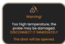
Если щуп вставлен, а температура в камере духовки превышает 220 °С, на дисплее появится всплывающее ПРЕДУПРЕЖДЕНИЕ, и духовка автоматически откроет дверцу рабочей камеры. Этот функция будет активна до тех пор, пока щуп не будет вынут или пока температура внутри рабочей камеры не упадет ниже 220 °С.
