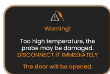
Gdy sonda jest włożona, a temperatura w komorze piekarnika przekracza 220°C, na wyświetlaczu pojawi się komunikat OSTRZEGAWCZY, a piekarnik automatycznie otworzy drzwiczki. Będzie działał do momentu wyjęcia sondy lub do momentu, gdy temperatura wewnątrz komory pieczenia nie spadnie poniżej 220°C.
