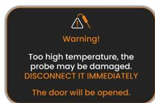
Avec la Sonde insérée et la température de la chambre du four supérieure à 220°C, cette fenêtre pop-up d'ALERTE apparaîtra à l'écran et le four ouvrira automatiquement la porte de la chambre de cuisson. Cet automatisme perdurera jusqu'au retrait de la sonde ou tant que la température à l'intérieur de la chambre de cuisson ne descendra pas en dessous de 220°C.
