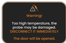
*Bij aangebrachte sonde en temperatuur van de ovenkamer hoger dan 220°C, verschijnt op het display deze pop-up voor WAARSCHUWING en zal de oven automatisch de oven deur openen. Deze automatische functie blijft aangehouden tot de sonde wordt verwijderd of tot de temperatuur in de ovenkamer onder de 220°C daalt.*
