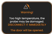
Con la Sonda insertada y temperatura de la Cavity del horno superior a 220°C, aparecerá esta ventana emergente de ALERTA en la pantalla y el horno abrirá automáticamente la puerta de la cavity de cocción. Este automatismo permanecerá, hasta que se retire la sonda o la temperatura en el interior de la cavity de cocción descienda por debajo de 220°C.
