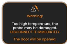
Con la Sonda inserita e temperatura della Cavità del forno superiore a 220°C, comparirà questo pop-up di ALLERTA nel display ed il forno aprirà automaticamente lo sportello della cavità di cottura. Questo automatico rimarrà, finché non verrà rimossa la sonda o fino a quando la temperatura all'interno della cavità di cottura non scenderà sotto i 220°C.
