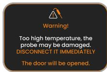
Bei eingesetzter Sonde und Temperatur des Ofenraums über 220°C erscheint dieses Pop-up zur WARNUNG am Display und der Ofen öffnet automatisch die Türe des Garraums. Dieser Automatismus verbleibt, bis die Sonde entfernt wird oder die Temperatur im Inneren des Garraums unter 220°C sinkt.
